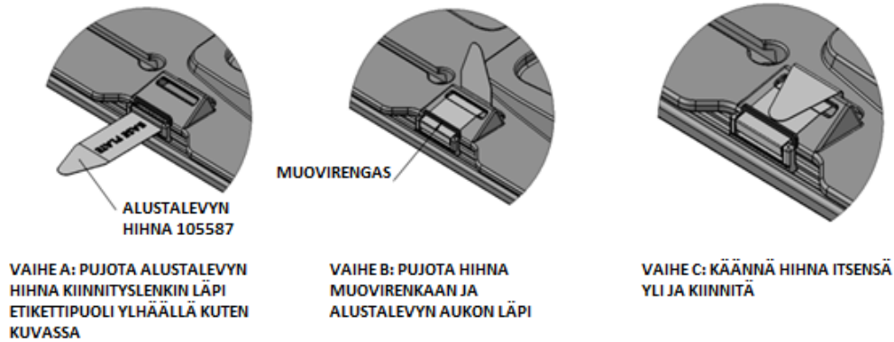
Kuva 6 Hihnojen kiinnitys
