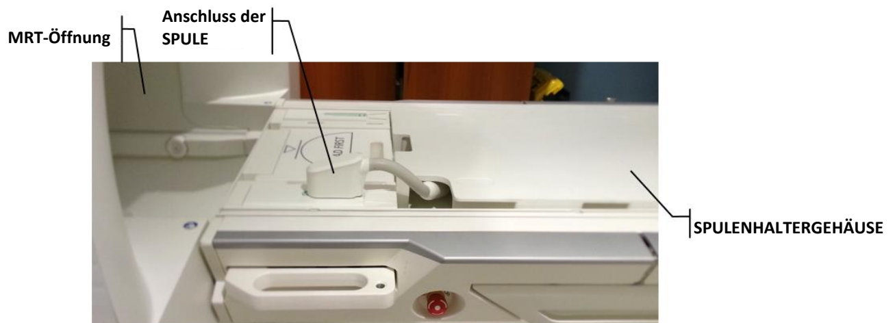
Abbildung 9: Richtiges Anbringen des Spulhalters und des Spulenkabels
