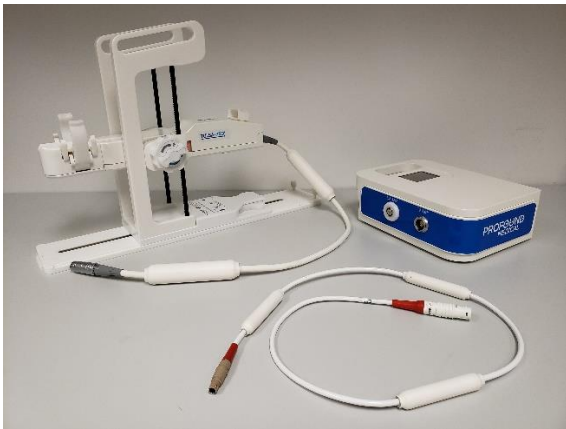
Abbildung 2: Hardware-Kit mit Spulenhalter, PS 104491, PSIB 104494 und UA-Kabel 105485
