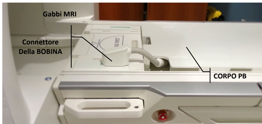
Figura 6: posizionamento corretto del portabobine e del cavo della bobina.
