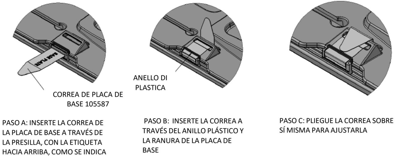
Figura 5. Fijación de las correas.
