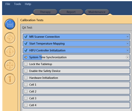
图 102: 自动 QA 测试已成功通过前三个阶段，现在执行 System Time Synchronization（系统时间同步）。
