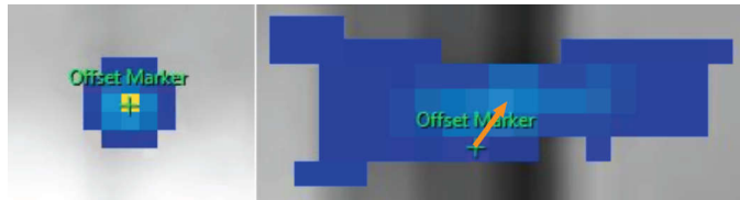
图 80: 如果偏移标记没有显示在升温区域中心, 请将偏移标记手动拖至升温区域中心。
