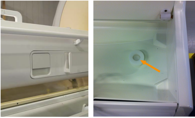
图 8: 左: 扫描床释放手柄。 右: 位于附件箱内的扫描床释放按钮。
