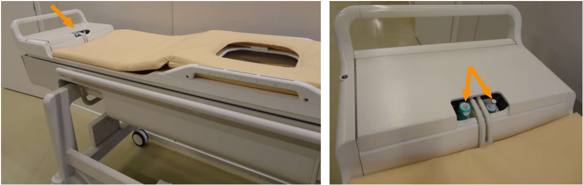
图 6: 如果以升级的形式安装 DISC, 软管连接器将位于扫描床前端的附件箱内。
