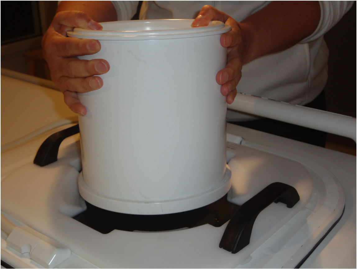
图 97: 将 QA 水模的一边放在水模平面上。 轻轻地将 QA 水模降至水模平面上。
