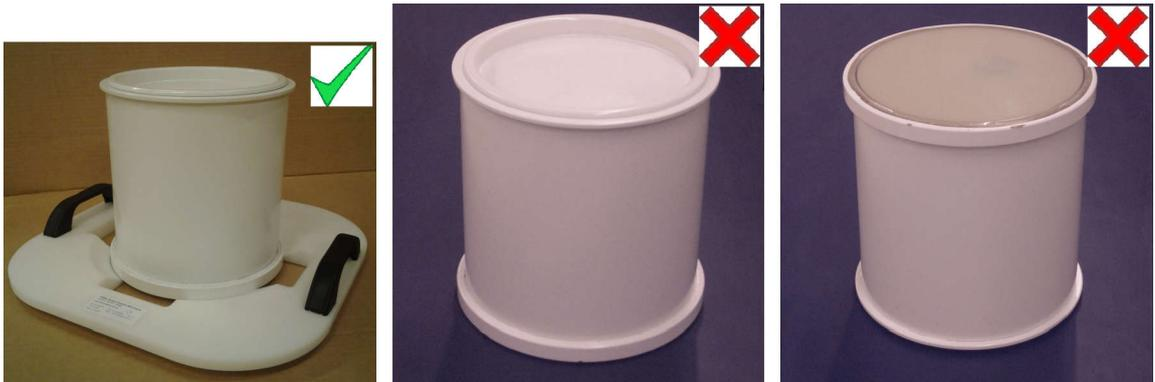
图 105: 将 QA 水模存放在 QA 水模平面上，隔膜面朝下。
