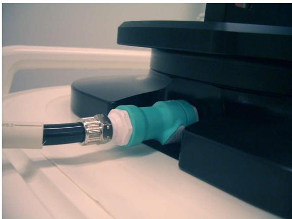
4. 将进水软管另一端连接至 Sonalleve 扫描床中的软管母连接器。
