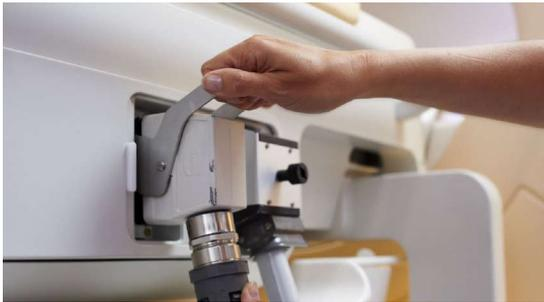
图 48: 扫描床连接器面板。
