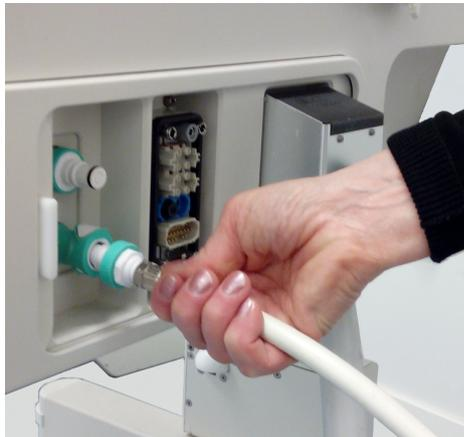
如果在出厂时已预装 DISC，软管连接器将位于扫描床连接器面板上。
