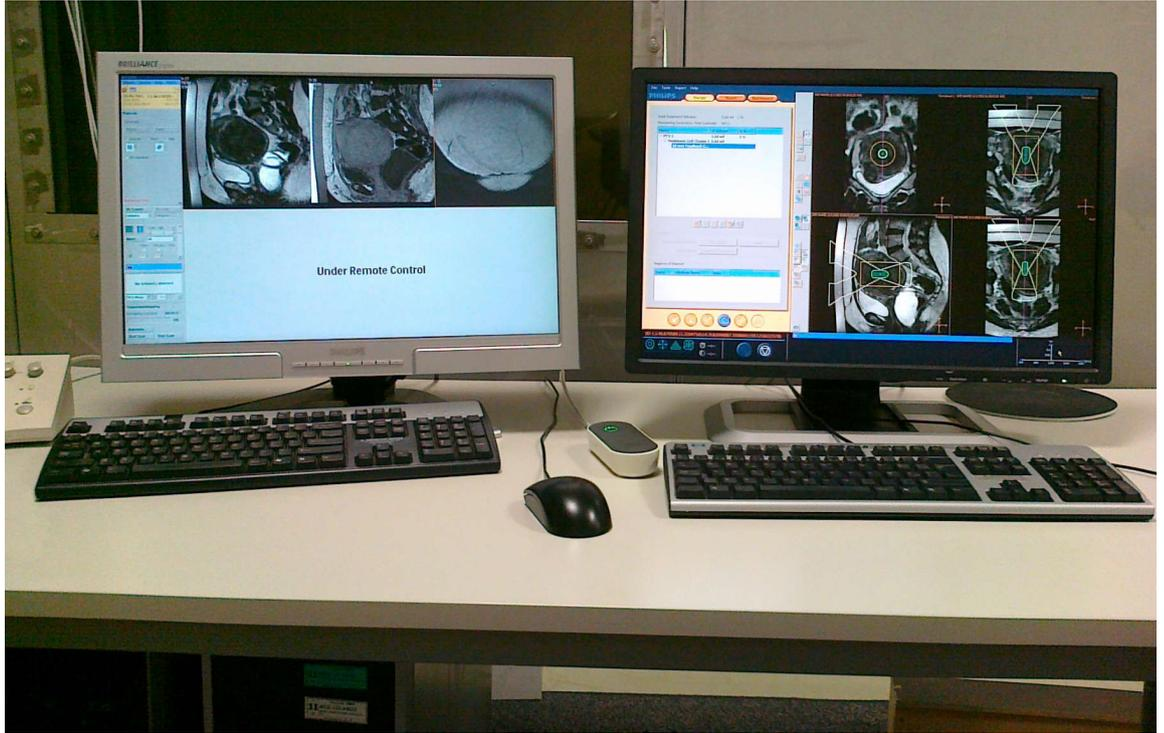
图 9: SonaIleve 控制台操作员工作站。左侧, MR 扫描仪控制台; 右侧, SonaIleve 控制台。
