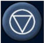
SonaIleve MR-HIFU 用户界面上提供一个软件中止超声消融按钮，用于中断超声消融。在不存在危险的情况下使用软件中止超声消融按钮，例如在计划治疗时间结束前组织温度达到目标温度时。
