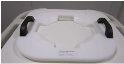
图 95: QA 水模平面。
