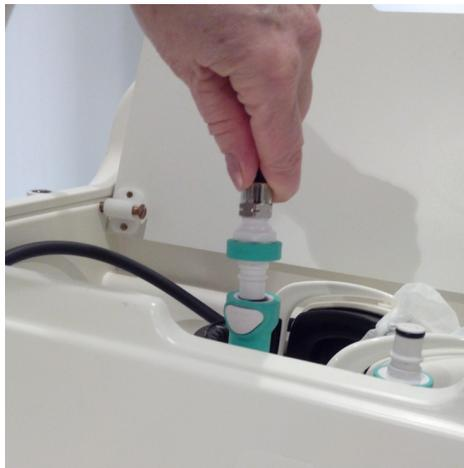
如果以升级的形式安装 DISC，软管连接器将位于扫描床前端的附件箱内。
