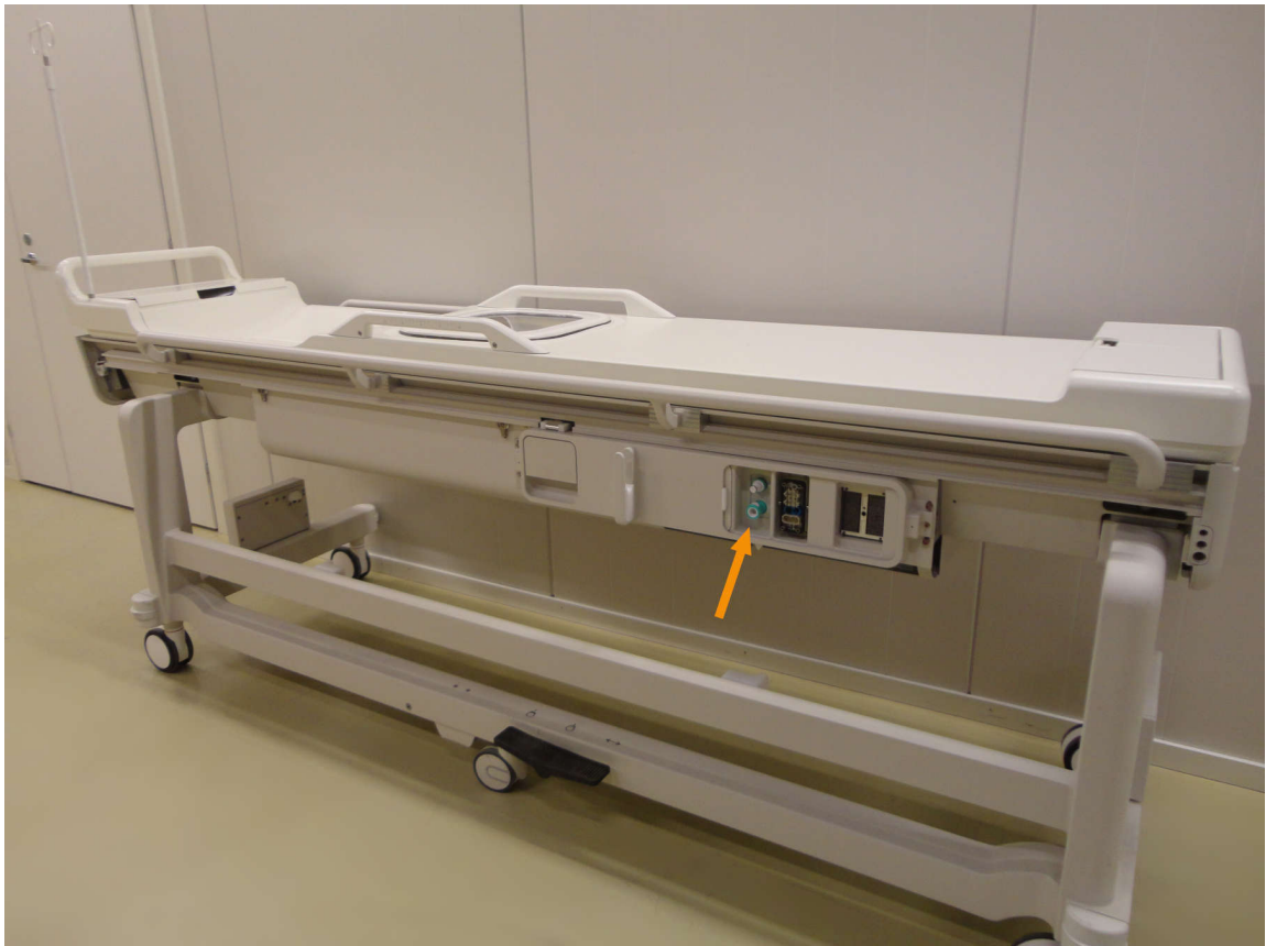
그림 5: 출고 전에 DISC 가 미리 탑재된 경우 호스 커넥터가 테이블 상판 커넥터 패널에 위치하게 됩니다.
