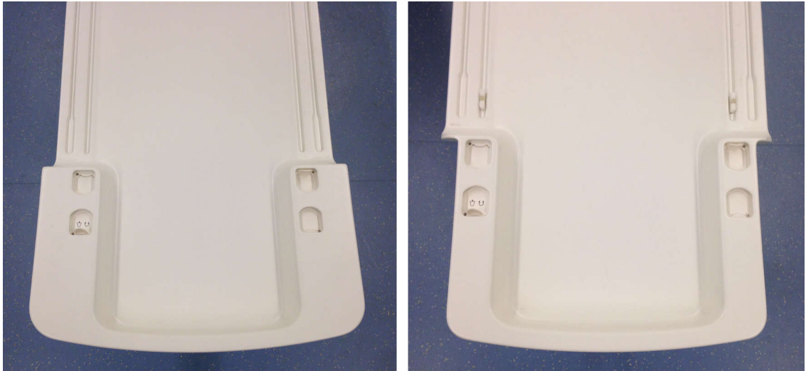
그림 47: 왼쪽: 이러한 유형의 Ingenia 얇은 테이블 상판은 Sonalleve 테이블 상판을 위치시키기 전에 먼저 제거해야 합니다. 오른쪽: 끝 부분이 더 좁은 이러한 유형의 Ingenia 얇은 테이블 상판인 경우는 Ingenia 얇은 테이블 상판을 제거하지 않고도 Sonalleve 테이블 상판을 제자리에 위치시킬 수 있습니다.
