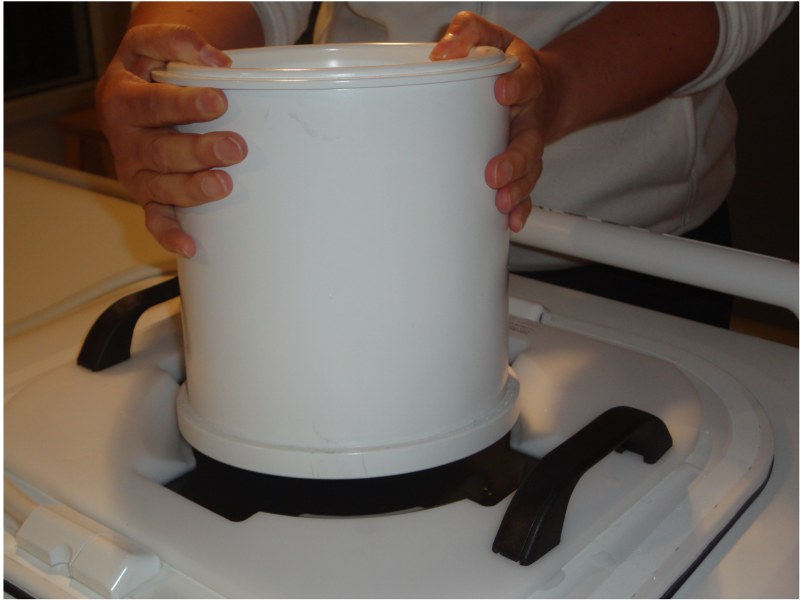
그림 98: QA 팬텀의 한쪽 가장자리를 팬텀 플레이트 위에 놓습니다. QA 팬텀을 팬텀 플레이트 위로 조심스럽게 내립니다.
