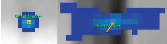
그림 81: 오프셋 마커가 온도 상승 영역 한가운데에 나타나지 않을 경우 수동으로 오프셋 마커를 온도 상승 영역 한가운데로 끌어다 놓습니다.
