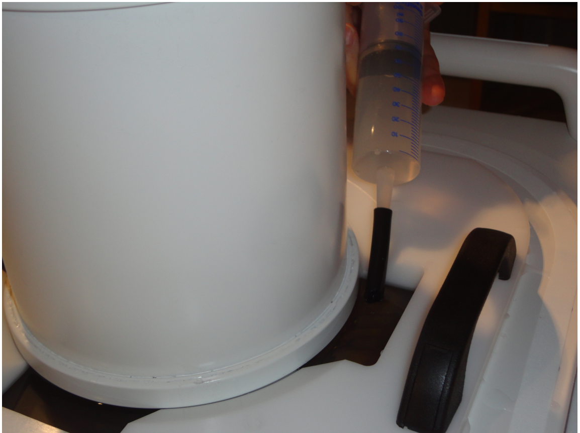
그림 99: 탈기수로 팬텀 아래에 남아 있는 에어 포켓을 채우는 과정 7. HIFU 골반 코일을 사용해 QA 팬텀을 자리에 고정합니다.
