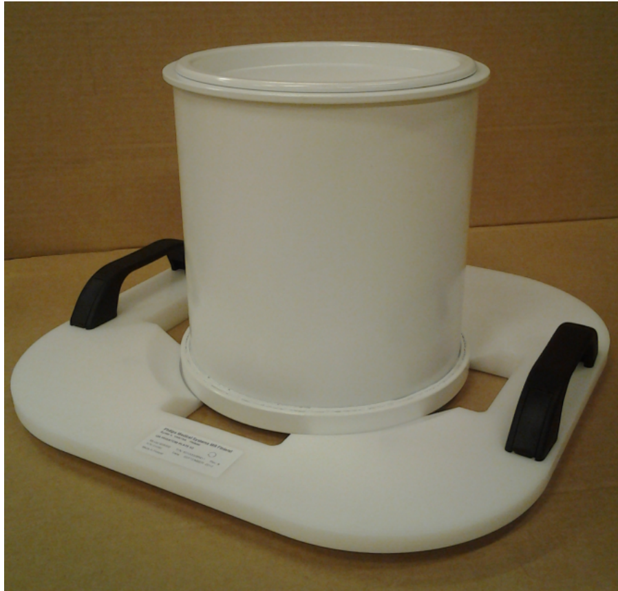
图 116: QA 水模平面上的 Sonalleve QA 水模型号 4510 000 82232。
