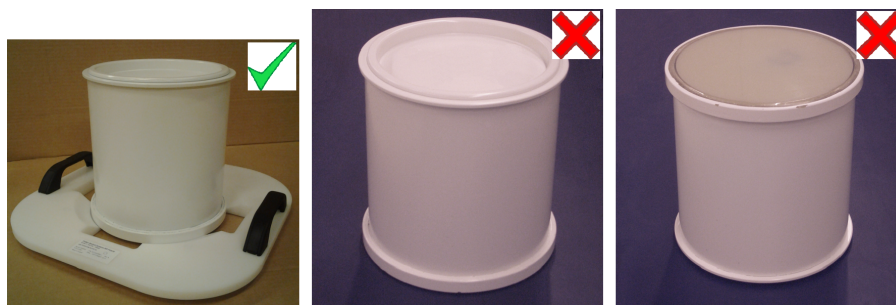
图 113: 将 QA 水模存放在 QA 水模平面上，隔膜面朝下。
