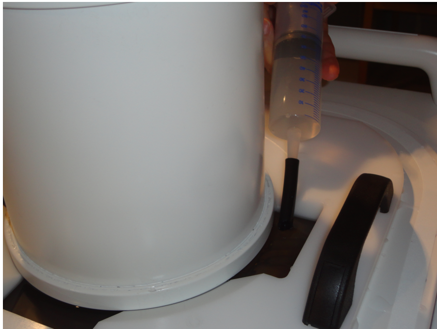
图 106: 使用脱气水填充水模下方任何残留的气囊。
