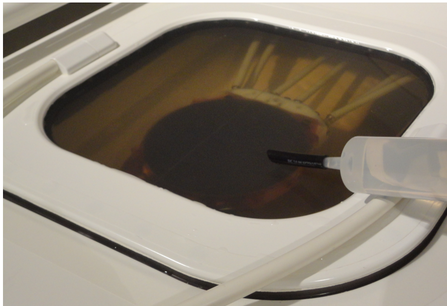
图 102: 用脱气水准备 Sonalleve 扫描床供水模使用。
