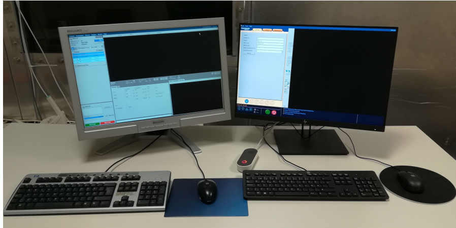
图 9: Sonalleve 控制台操作员工作站。左侧，MR 扫描仪控制台；右侧，Sonalleve 控制台。
