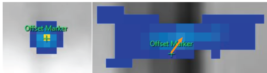
图 86: 如果偏移标记没有显示在升温区域中心, 请将偏移标记手动拖至升温区域中心。
