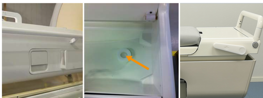
图 8: 左：扫描床释放手柄。中间：位于附件箱内的紧急扫描床释放按钮。 右：位于附件箱侧面的紧急扫描床释放手柄。
