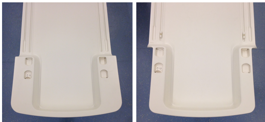
图 50: 左：需要将这类 Ingenia 薄扫描床移出之后才能将 Sonalleve 扫描床放置到位。右：这类 Ingenia 薄扫描床的较窄端允许在不移出 Ingenia 薄扫描床的情况下将 Sonalleve 扫描床放置到位。
