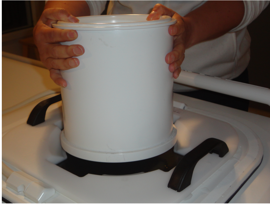
图 105: 将 QA 水模的一边放在水模平面上。轻轻地将 QA 水模降至水模平面上。
