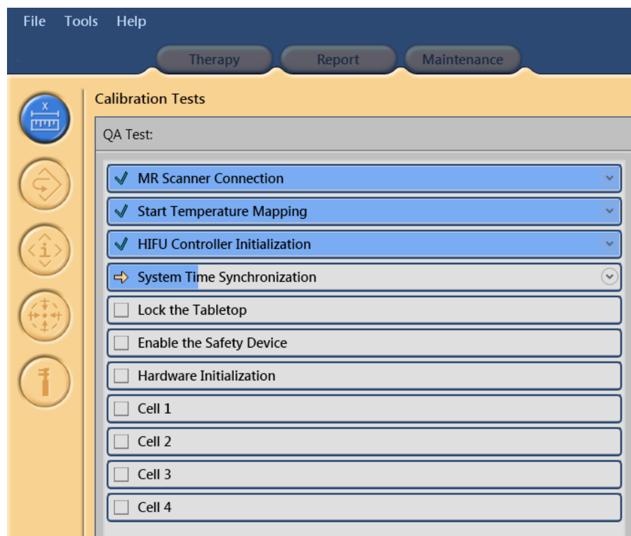
图 110: 自动 QA 测试已成功通过前三个阶段，现在执行 System Time Synchronization（系统时间同步）。
