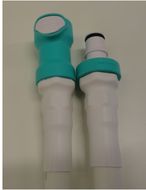
Afb. 55: Sluit de twee connectors in de DISC-slangen aan op de connectors in het Sonallevet-tafelblad.
