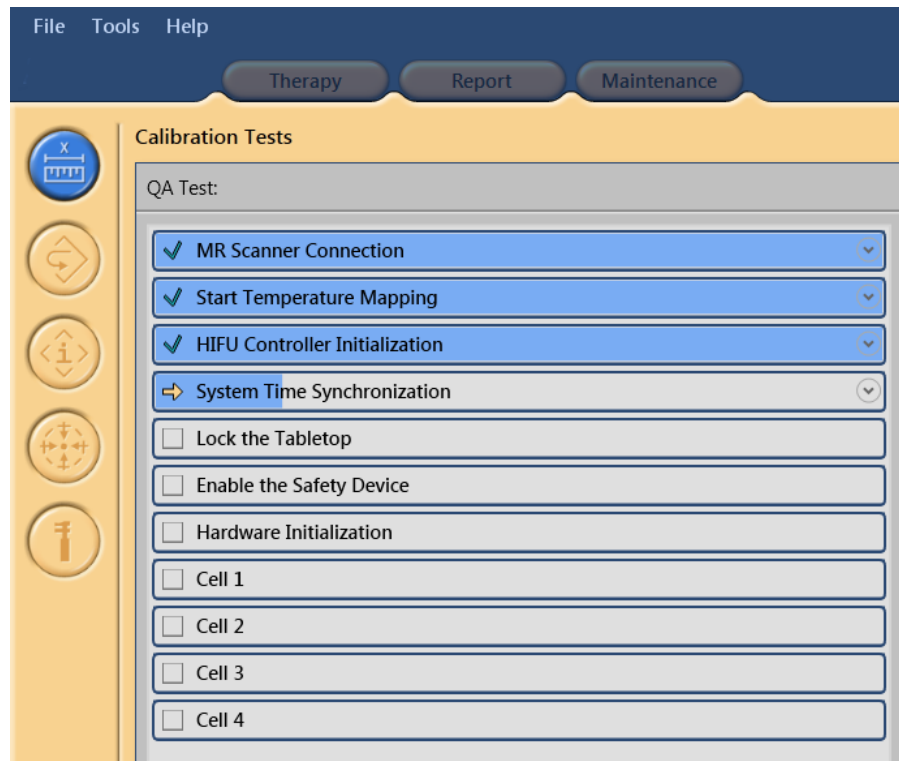
Afb. 118: De automatische QA-test heeft de eerste drie fasen met succes doorlopen en voert nu de Systeemtijdsynchronisatie uit.
