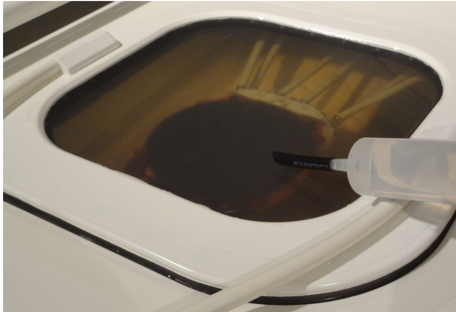
Afb. 110: Het Sonalleve-tafelblad met ontgast water voorbereiden op het fantoom.
