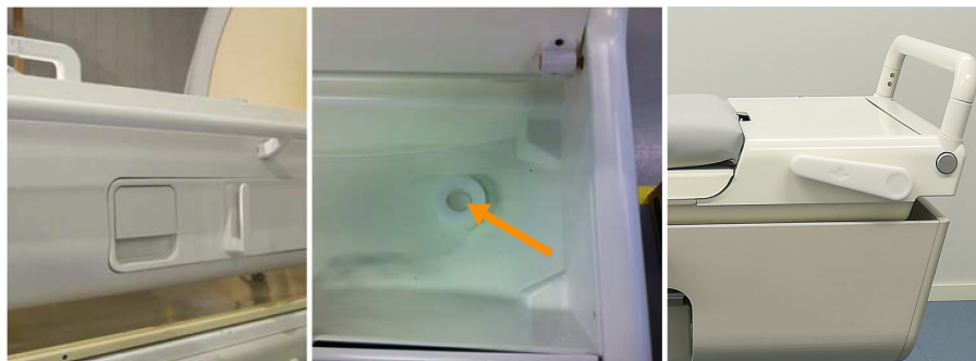
Afb. 8: Links: Hendel voor ontgrendeling van het tafelblad. Midden: de noodontgrendelknop van het tafelblad bevindt zich in het accessoirevak. Rechts: de noodontgrendelhendel van het tafelblad bevindt zich aan de zijkant van het accessoirevak.
