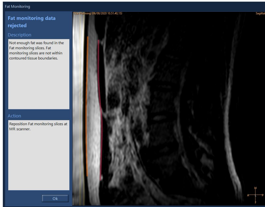
Afb. 38: Het dialoogvenster Vetbewaking toont de positie van de T2- vetbewakingsscan ten opzichte van weefselgrenzen. Het geeft ook meer informatie over waarom de vetbewakingsgegevens niet konden worden gebruikt. Het beeld kan worden gewindowd met behulp van de standaardhulpmiddelen.
