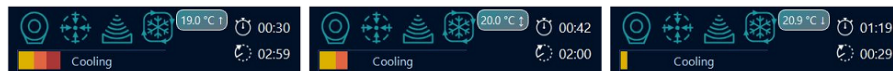
Afb. 20: Drie voorbeelden van afkoeltijd in de Systeemstatusweergave. Links: bijna een derde van de resterende door het systeem aanbevolen afkoeltijd is verplicht en kan niet worden overgeslagen. Midden: De afkoelperiode kan worden overgeslagen omdat er geen verplichte afkoeltijd is, maar het systeem geeft een hoog risico op interne brandwonden aan. Rechts: De aanbevolen afkoeltijd is niet verstreken, maar het is mogelijk om deze over te slaan en de sonicatie te starten.
