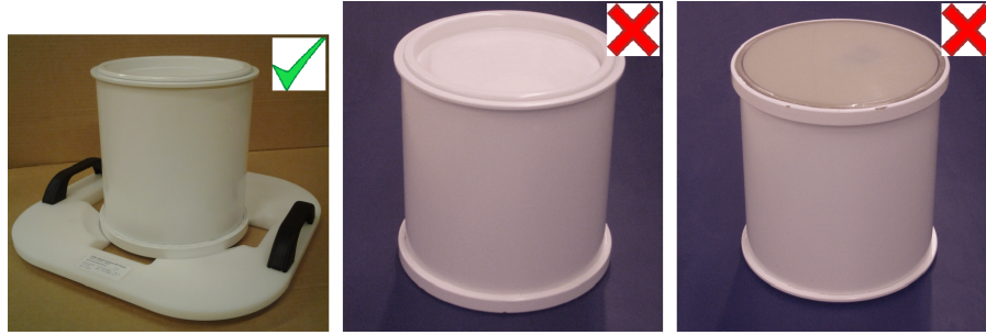
Afb. 121: Bewaar het QA-fantoom op de QA-fantoomplaat met het membraan naar beneden.
