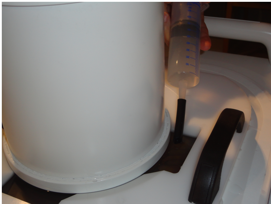
Abb. 114: Auffüllen verbleibender Lufttaschen mit entgastem Wasser.
