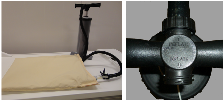
Abb. 125: Luftpumpe. Rechts: Luftschlauch, an der Seite „Deflate“ (Ablassen) des Handgriffs angeschlossen.
