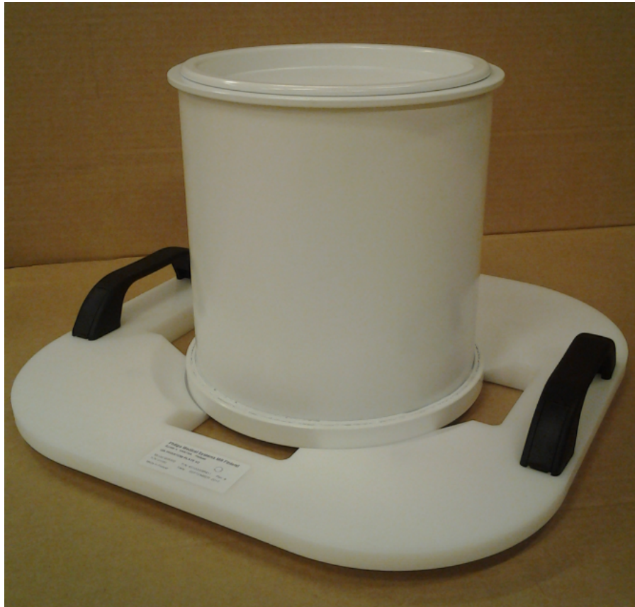
Abb. 124: Sonalleve QS-Phantom, Modell 4510 000 82232, auf der Platte für das QS-Phantom.
