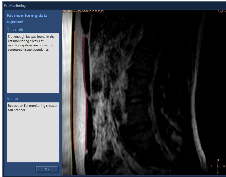
Abb. 38: Im Dialogfeld „Fettüberwachung“ wird die Position der T2-Fettüberwachungsmessung im Verhältnis zu den Gewebegrenzen angezeigt. Es bietet auch mehr Informationen darüber, warum die Fettüberwachungsdaten nicht verwendet werden konnten. Das Bild kann mit den Standardwerkzeugen im Fenster angezeigt werden.
