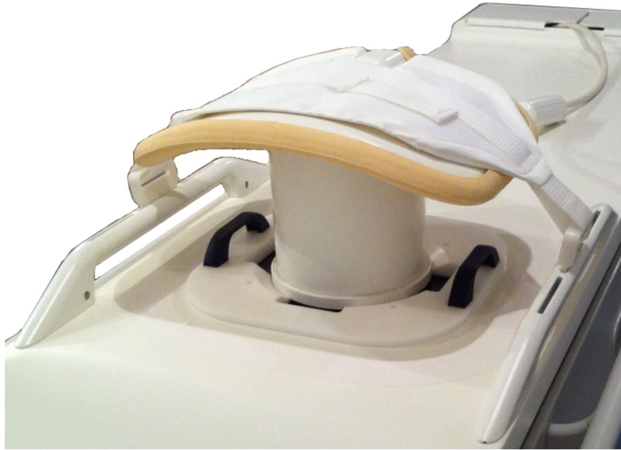
Abb. 115: QS-Phantom bereit zur Schallexposition.
