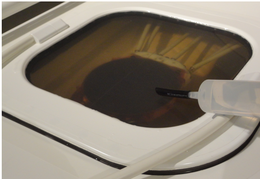
Abb. 110: Vorbereiten der Sonalleve-Tischplatte mit entgastem Wasser für das QA-Phantom.
