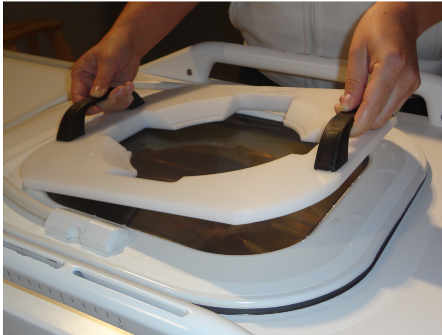
Abb. 112: Aufsetzen der Platte für das QS-Phantom auf das Ultraschallfenster.
