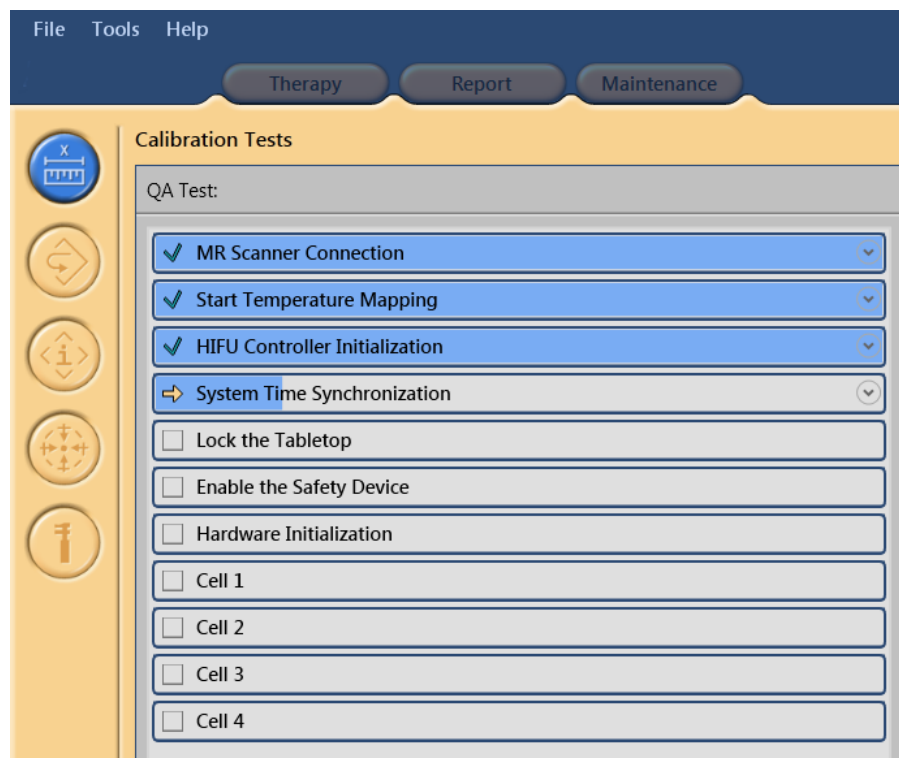
Abb. 118: Der automatische Qualitätssicherungstest hat die ersten drei Phasen erfolgreich bestanden und führt nun die Systemzeitsynchronisierung durch.
