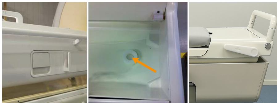
Kuva. 8: Vasemmalla: hoitopöydän vapautuskahva. Keskekuvassa: tarvikelaatikossa oleva hoitopöydän hätävapautuspainike. Oikealla: tarvikelaatikon sivulla oleva hoitopöydän hätävapautuskahva.
