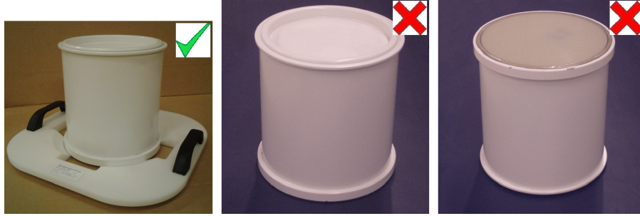
Kuva. 121: Säilytä QA-fantomi QA-fantomilevyn päällä niin, että kalvo osoittaa alaspäin.
