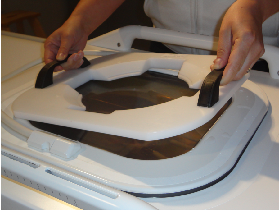
Kuva. 112: QA-fantomilevyn asettaminen ultraääni-ikkunan päälle.
