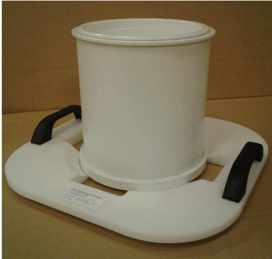
Kuva. 124: Sonalleve-QA-fantomi, malli 4510 000 82232, oikein säilytettynä QA-fantomitelineessä.
