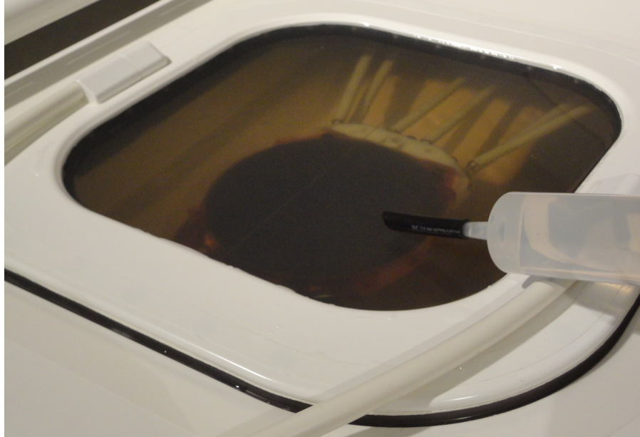
Kuva. 110: Sonalleve-hoitopöydän valmistelu kaasuttomalla vedellä fantomia varten.
