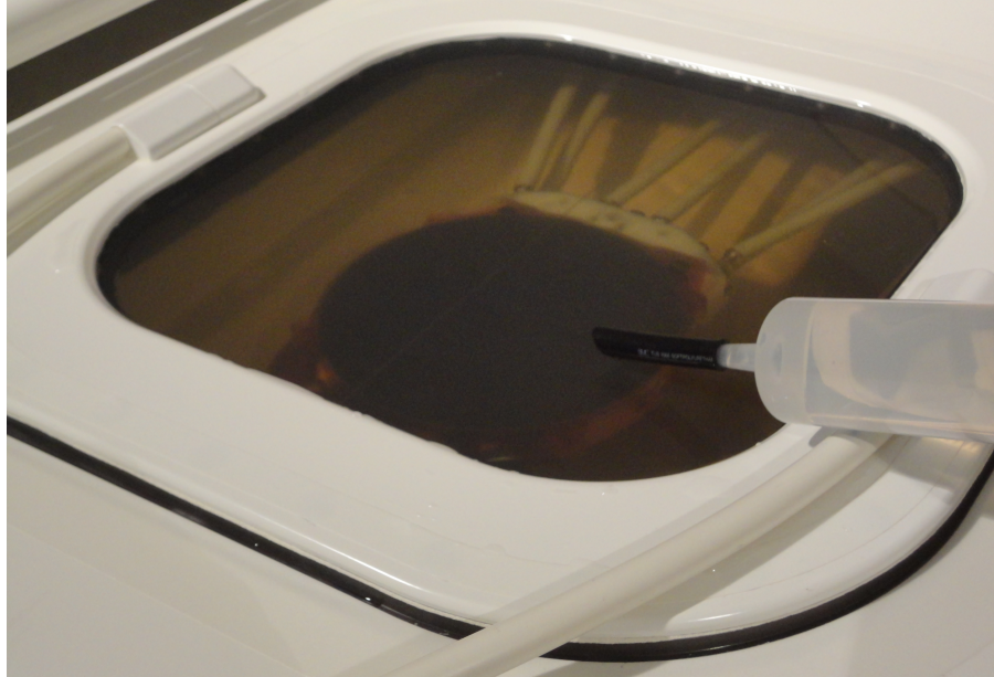
Kuva. 110: Sonalleve-hoitopöydän valmistelu kaasuttomalla vedellä fantomia varten.
