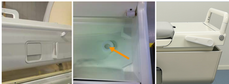
Hình 8: Trái: Tay cầm tháo Mặt bàn. Giữa: Nút tháo Mặt bàn khẩn cấp nằm trong hộp phụ kiện. Phải: Tay cầm tháo Mặt bàn khẩn cấp nằm ở phía có hộp phụ kiện.
