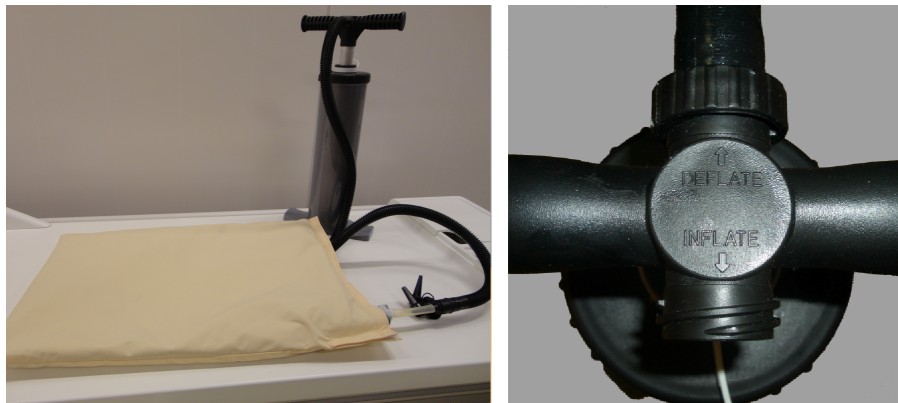
Hình 125: Bơm khí. Phải: Ống dẫn không khí được nối với đầu Deflate (Tháo hơi) của tay cầm.
