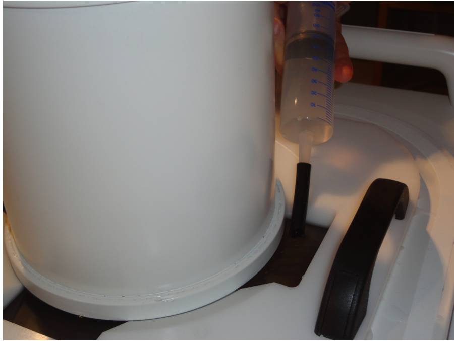
Hình 114: Đổ đầy mọi túi khí còn sót lại dưới nệm bằng nước đã khử khí.
