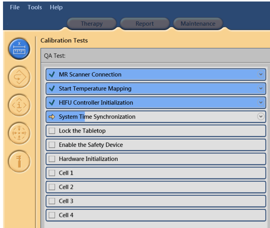
Hình 118: Kiểm tra QA tự động đã vượt qua thành công ba giai đoạn đầu tiên và hiện đang thực hiện Đồng bộ hóa thời gian hệ thống.
