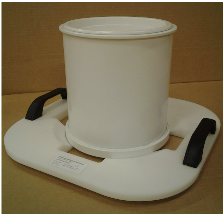
Hình 124: Nộm QA Sonallevé model 4510 000 82232 trên Tấm đế nộm QA.
