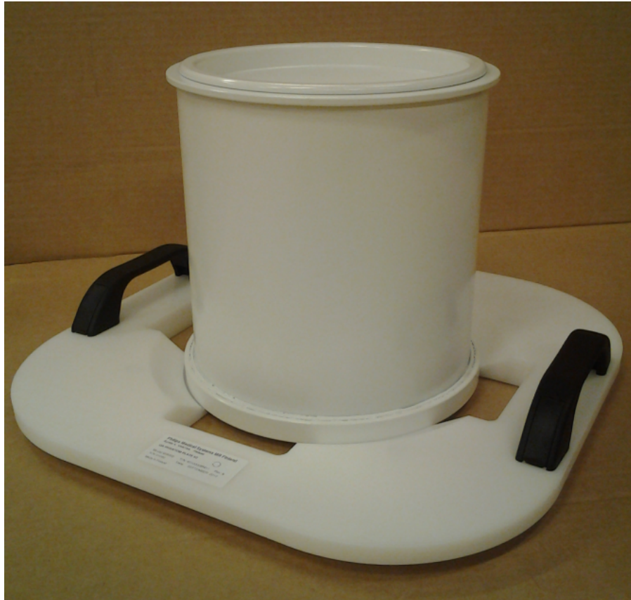
Kuva. 115: Sonalleve-QA-fantomi, malli 4510 000 82232, oikein säilytettynä QA-fantomitelineessä.
