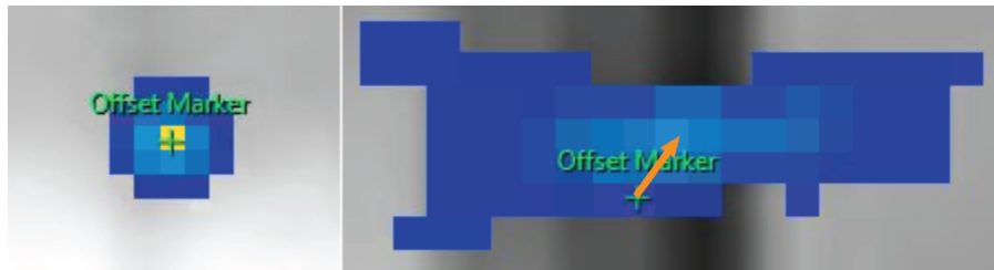
Kuva. 87: Jos lämmenneen alueen keskikohtaan ei ilmesty siirtymämerkkiä, vedä merkki lämmenneen alueen keskikohtaan manuaalisesti.
