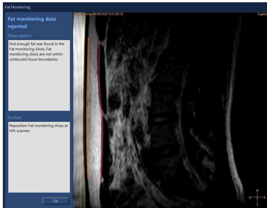
Kuva. 38: Fat Monitoring (Rasvakerroksen valvonta) -valintaikkunassa näkyy rasvakerroksen T2-kuvauksen sijainti suhteessa kudoksen reunoihin. Valintaikkunassa on myös lisätietoja siitä, miksi rasvakerroksen valvontatietoja ei voitu käyttää. Kuvaa ei voi ikkunoida vakiotyökaluilla.
