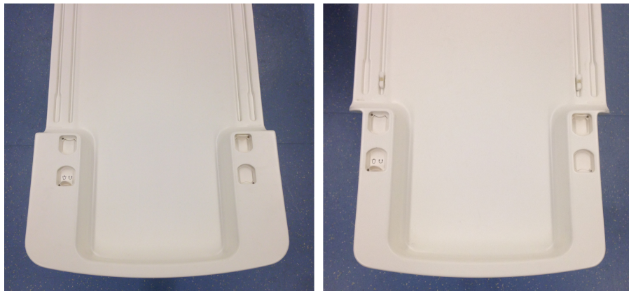
Kuva. 51: Vasemmalla: tällainen ohut Ingenia-pöytälevy on poistettava ennen Sonalleve-hoitopöydän asettamista paikalleen. Oikealla: koska tällaisen ohuen Ingenia-pöytälevyn pää on kapea, Sonalleve-hoitopöydän voi asettaa paikalleen Ingenia-pöytälevyä poistamatta.
