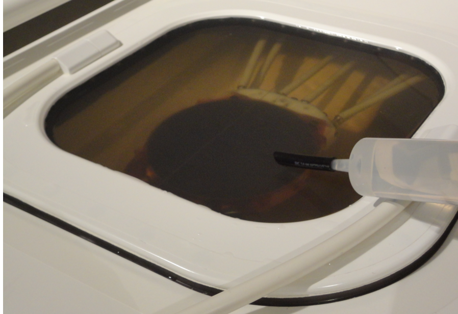
Kuva. 101: Sonalleve-hoitopöydän valmistelu kaasuttomalla vedellä fantomia varten.
