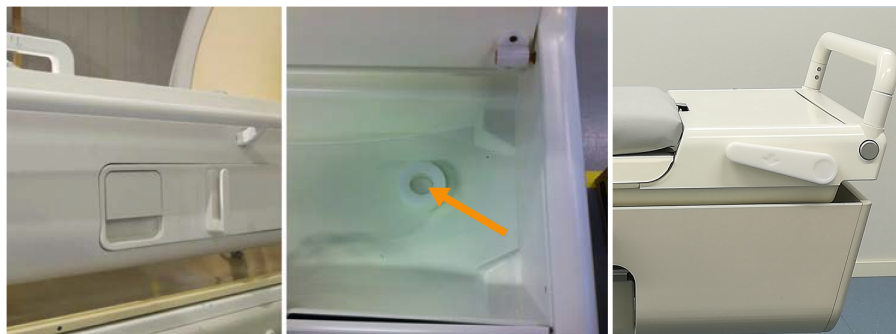
Kuva. 8: Vasemmalla: hoitopöydän vapautuskahva. Keskikuvassa: tarvikelaatikossa oleva hoitopöydän hätävapautuspainike. Oikealla: tarvikelaatikon sivulla oleva hoitopöydän hätävapautuskahva.
