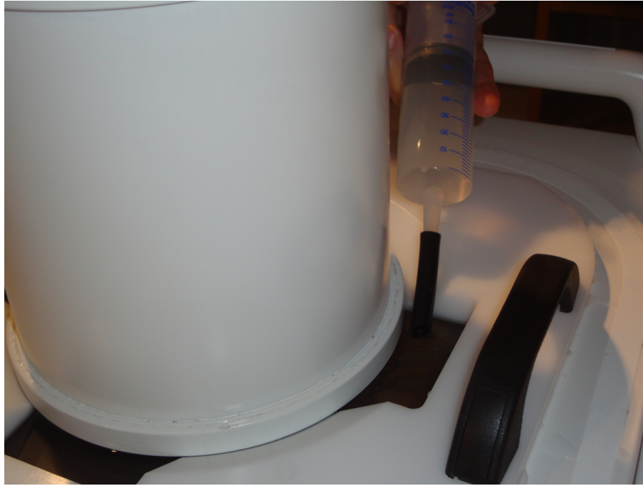
Kuva. 105: Täytä mahdolliset fantomin alla olevat ilmataskut kaasuttomalla vedellä.
