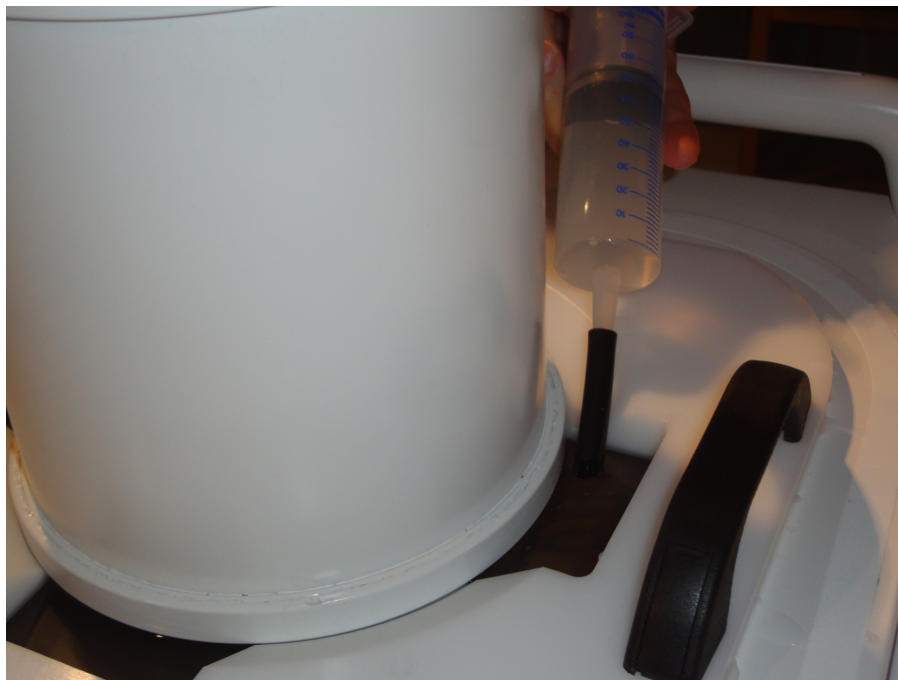
Fig. 114: Remplir toutes les poches d'air restantes situées sous le fantôme avec de l'eau dégazée.
