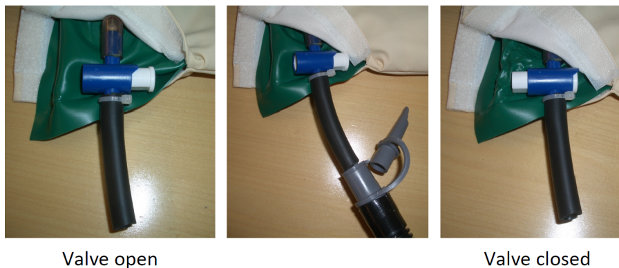
Fig. 128: Autre type de valve. À gauche : la valve est ouverte ; au centre : le tuyau d'air est branché ; à droite : la valve est fermée et le tuyau d'air a été détaché.
