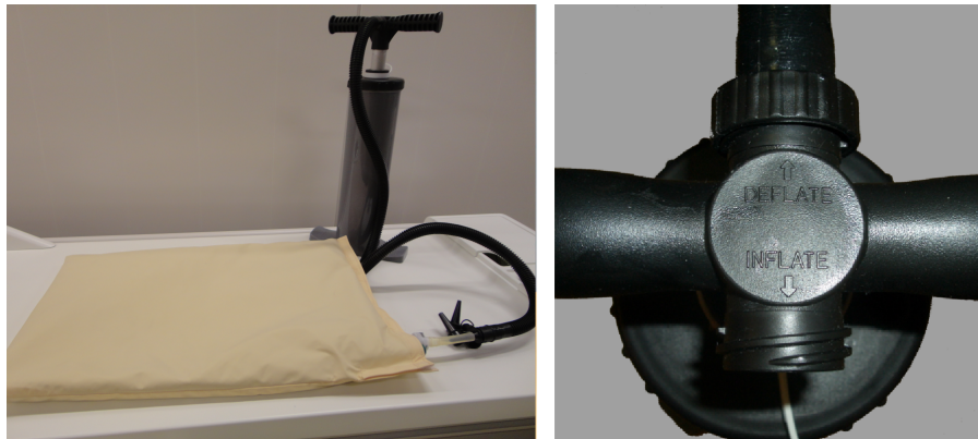
Fig. 125: Pompe à air. À droite : tuyau d'air branché sur l'extrémité de dégonflage (DEFLATE) de la poignée.
