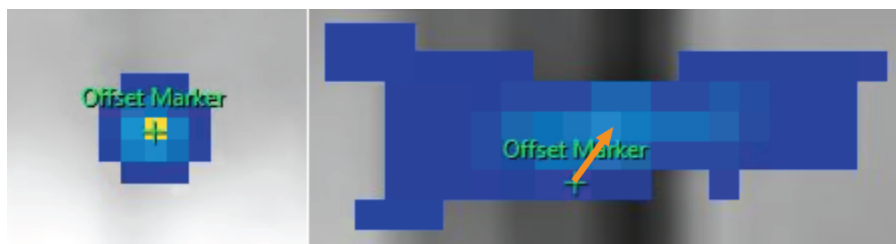
Fig. 93: Si le marqueur de décalage n'apparaît pas au centre de la zone échauffée, faites-le glisser manuellement jusqu'à cette position.
