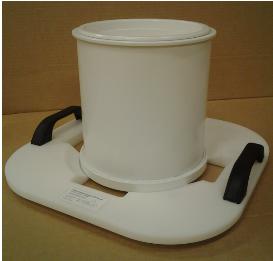
Fig. 124: Fantôme QA du système Sonalleve modèle 4510 000 82232 installé sur la plaque de fantôme QA.
