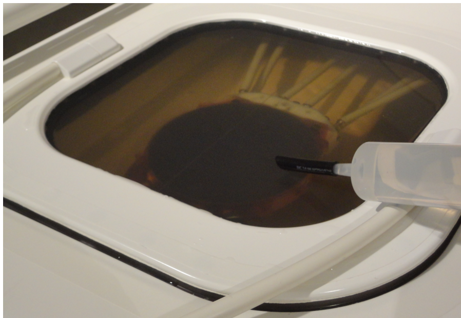
Fig. 110: Préparation du plan d'examen Sonalleve avec de l'eau dégazée pour le fantôme.
