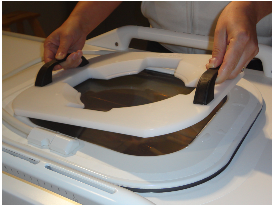
Fig. 112: Positionnement de la plaque de fantôme QA sur la fenêtre d'ultrasons.
