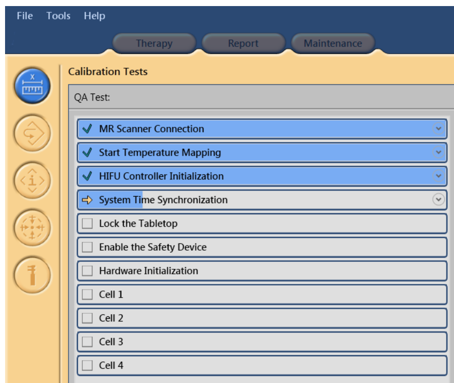
Fig. 118: Le test QA automatique a effectué avec succès les trois premières phases et est actuellement en train d'exécuter la phase Synchronisation de l'horloge du système.
