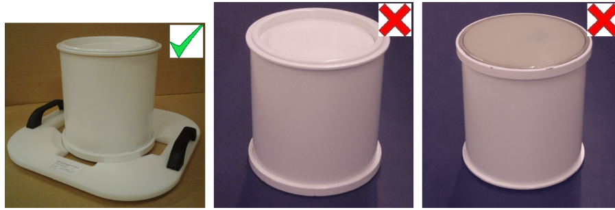
Fig. 121: Rangez le fantôme QA sur la plaque prévue à cet effet, membrane vers le bas.
