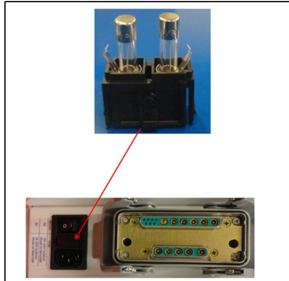
Figura 14: Colocación de la caja de fusibles
