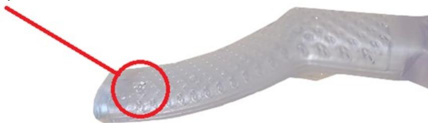
Figura 12: Lubricante saliendo de los poros del ECD
