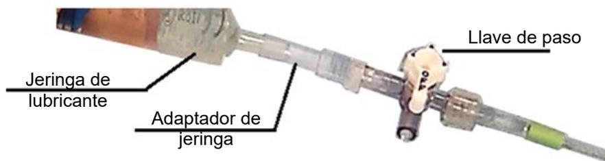
Figura 11: Jeringa de lubricante con adaptador y llave de paso
