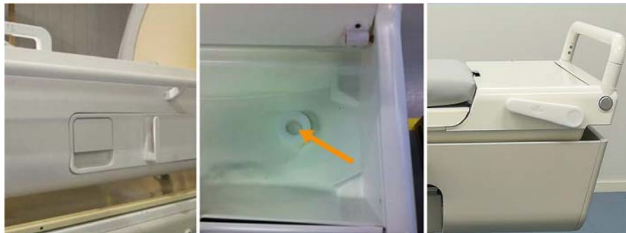
Afb. 9: Links: Hendel voor ontgrendeling van het tafelblad. Midden: de noodontgrendelknop van het tafelblad bevindt zich in het accessoirevak. Rechts: de noodontgrendelhendel van het tafelblad bevindt zich aan de zijkant van het accessoirevak.
