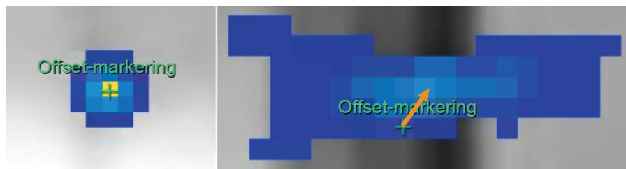
Afb. 96: Als de offset-markering niet wordt weergegeven op het middelpunt van de verwarming, sleept u de offset-markering handmatig naar het middelpunt van de verwarming.
