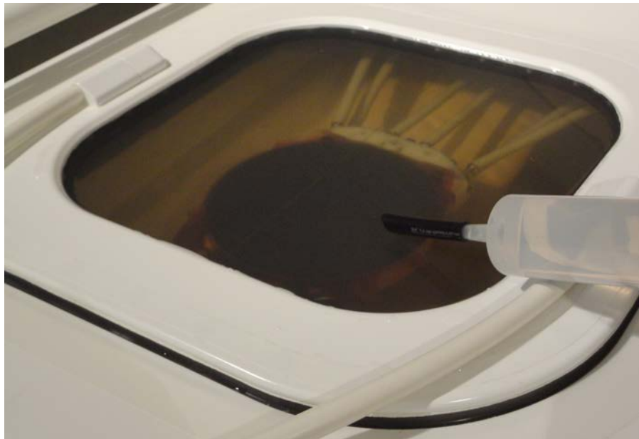
Afb. 112: De Sonalleve-patiënttafel met ontgast water voorbereiden op het fantoom.
