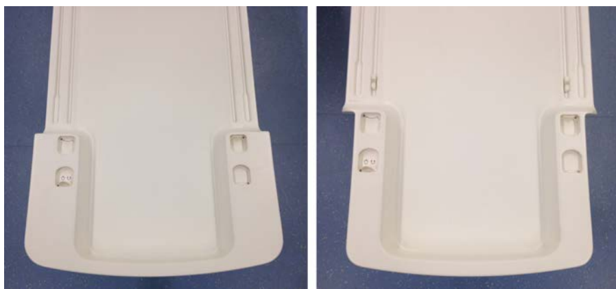
Afb. 54: Links: Dit type Ingenia dunne tafelbladen dient te worden verwijderd voordat het Sonalleve-tafelblad in positie kan worden gebracht. Rechts: Dankzij het smallere uiteinde van dit type Ingenia dunne tafelbladen kan het Sonalleve-tafelblad in positie worden gebracht zonder het Ingenia dunne tafelblad te verwijderen.
