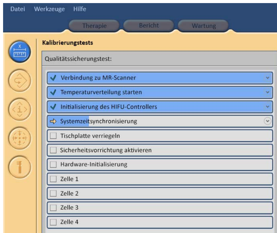
Abb. 120: Der automatische Qualitätssicherungstest hat die ersten drei Phasen erfolgreich bestanden und führt nun die Systemzeitsynchronisierung durch.
