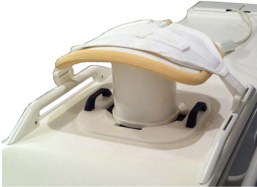
Abb. 117: QS-Phantom bereit zur Schallexposition.
