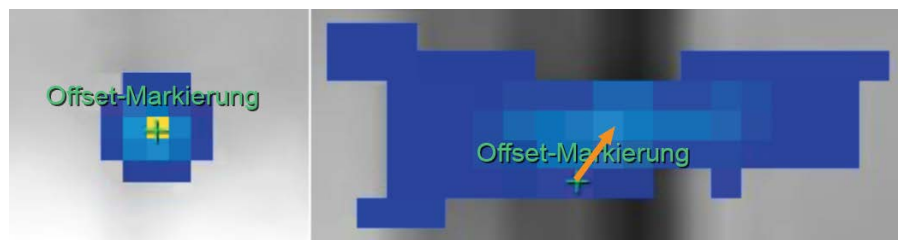
Abb. 96: Wenn die Offset-Markierung nicht im Zentrum des erwärmten Bereichs erscheint, die Offset-Markierung manuell ins Zentrum des erwärmten Bereichs ziehen.
