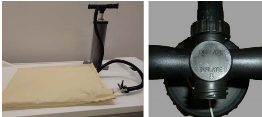
Abb. 127: Luftpumpe. Rechts: Luftschlauch, an der Seite „Deflate“ (Ablassen) des Handgriffs angeschlossen.
