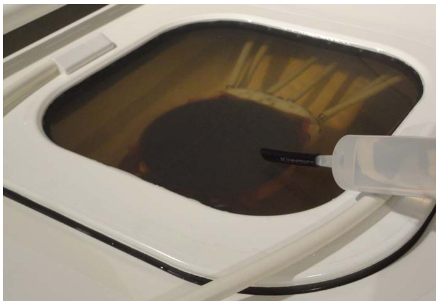
Abb. 112: Vorbereiten des Sonalleve-Patiententisches mit entgastem Wasser für das Phantom.
