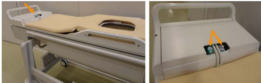
Kuva. 7: Jos ihonjäähdytyslaite asennetaan päivityksenä, letkuliittimet sijaitsevat potilaspöydän etupäädyn tarvikelaatikossa.
