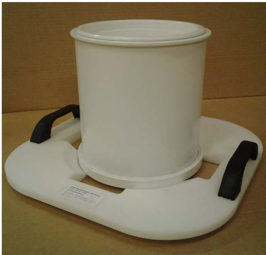
Kuva. 118: Sonalleve-QA-fantomi, malli 4510 000 82232, oikein säilytettynä QA-fantomitelineessä.
