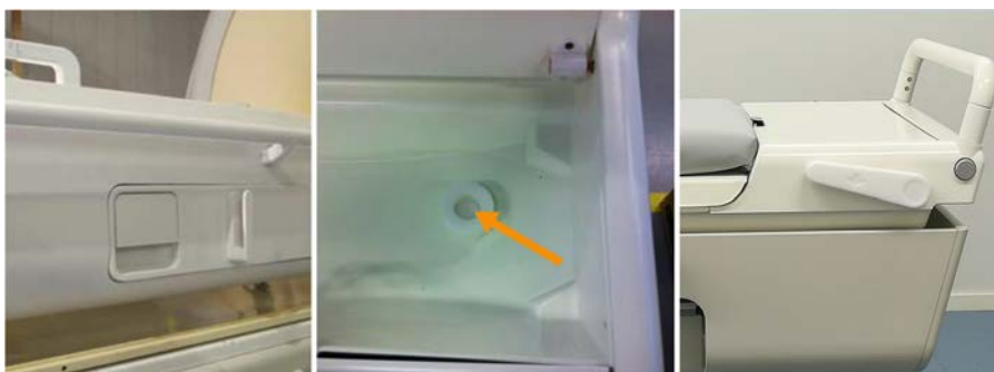
Kuva. 9: Vasemmalla: hoitopöydän vapautuskahva. Keskikuvassa: tarvikelaatikossa oleva hoitopöydän hätävapautuspainike. Oikealla: tarvikelaatikon sivulla oleva hoitopöydän hätävapautuskahva.
