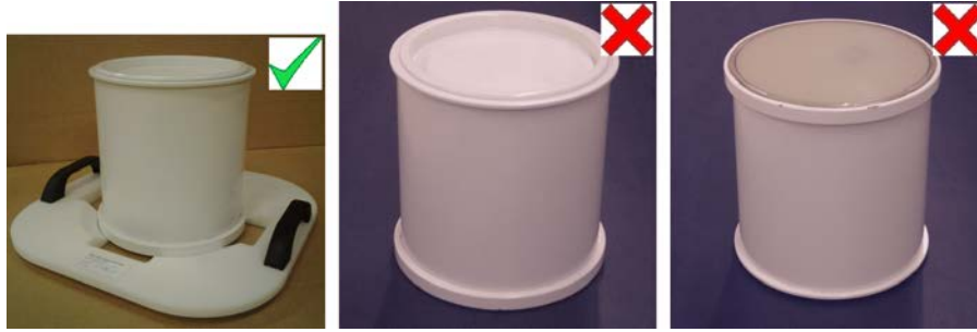
Kuva. 115: Säilytä QA-fantomi QA-fantomilevyn päällä niin, että kalvo osoittaa alaspäin.
