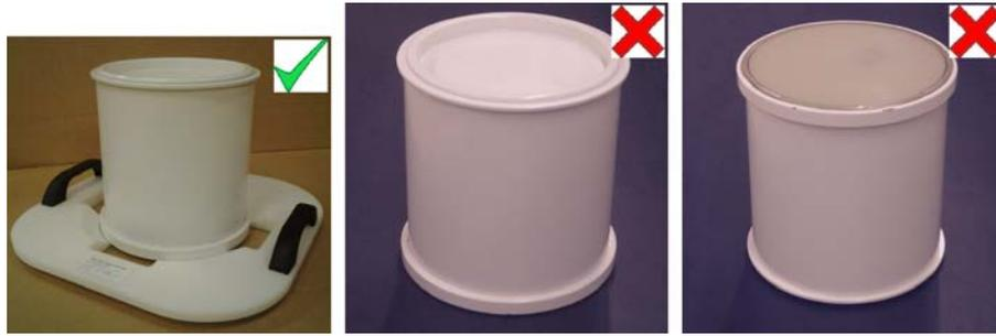
**Fig. 123:** Rangez le fantôme QA sur la plaque prévue à cet effet, membrane vers le bas.
