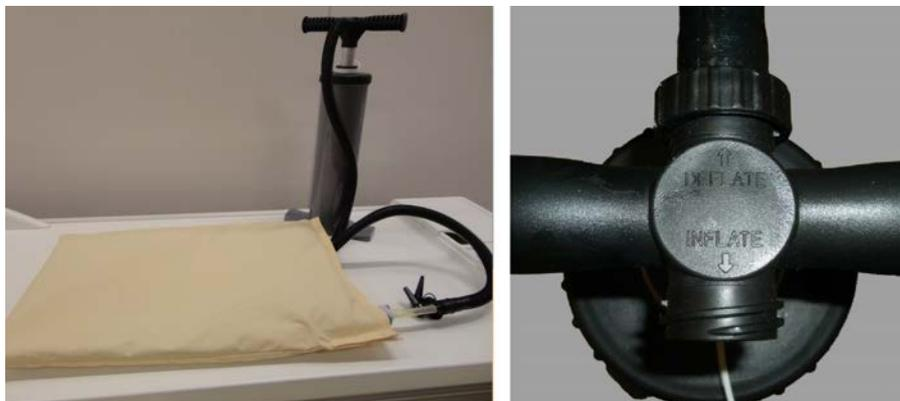
**Fig. 127:** Pompe à air. À droite : tuyau d'air branché sur l'extrémité de dégonflage (DEFLATE) de la poignée.
