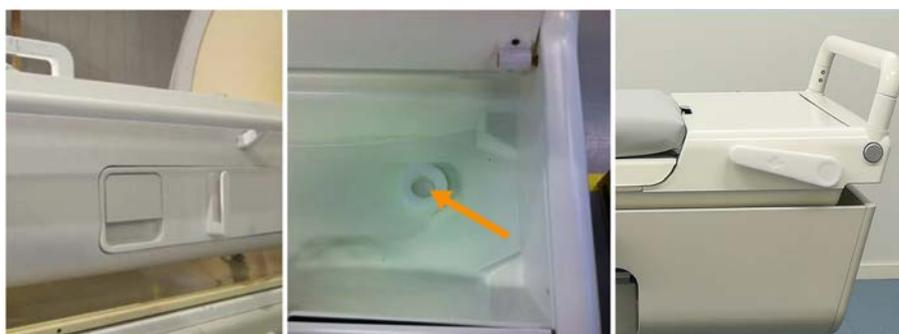
**Fig. 9:** À gauche : poignée de déverrouillage du plan d'examen. Au centre : bouton de déverrouillage d'urgence du plan d'examen disponible dans le boîtier des accessoires. À droite : poignée de déverrouillage d'urgence du plan d'examen disponible sur le côté du boîtier des accessoires.
