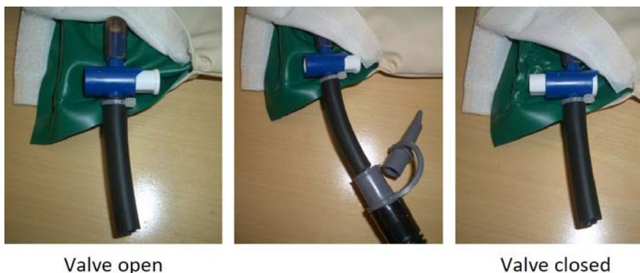
**Fig. 130:** Autre type de valve. À gauche : la valve est ouverte ; au centre : le tuyau d'air est branché ; à droite : la valve est fermée et le tuyau d'air a été détaché.
