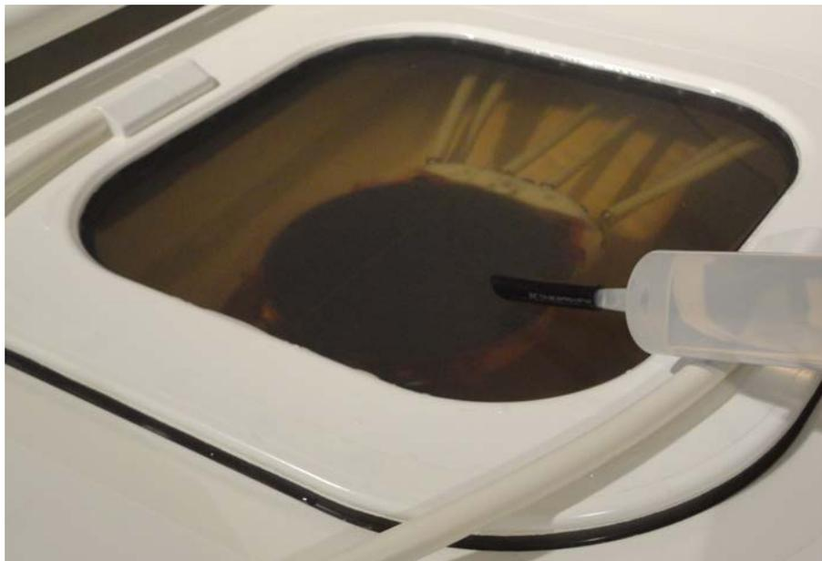
**Fig. 112:** Préparation de la table d'examen Sonalleve avec de l'eau dégazée pour le fantôme.
