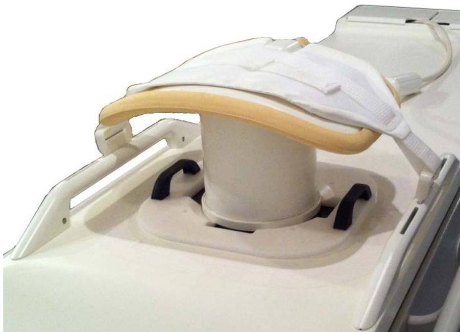
**Fig. 117:** Fantôme QA prêt pour l'émission d'ultrasons.
