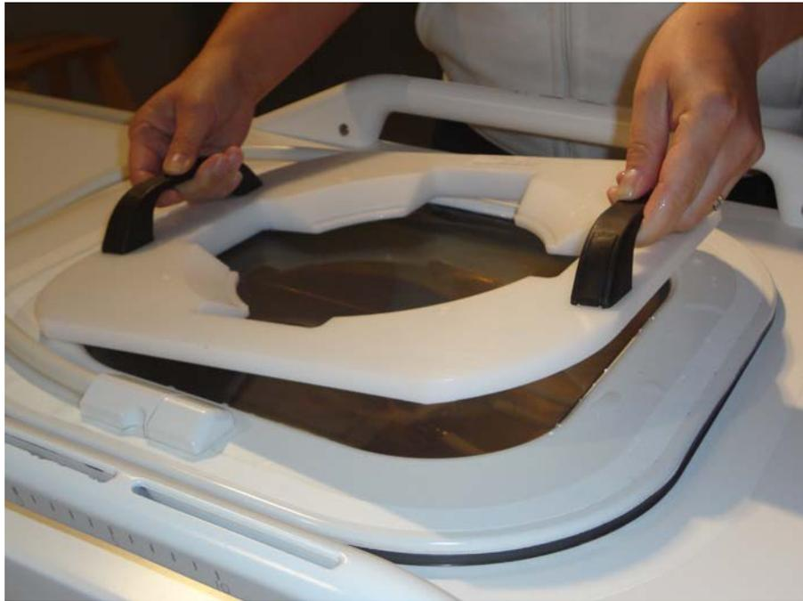
**Fig. 114:** Positionnement de la plaque de fantôme QA sur la fenêtre d'ultrasons.
