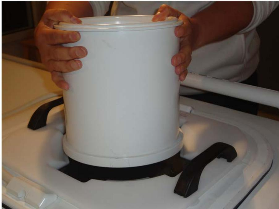
**Fig. 115:** Placer un bord du fantôme QA sur la plaque de fantôme. Abaisser délicatement le fantôme QA sur la plaque.
