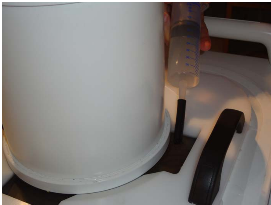
Afb. 112: Vul eventuele resterende luchtholtes onder het fantoom met ontgast water.
