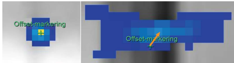
Afb. 94: Als de offset-markering niet wordt weergegeven op het middelpunt van de verwarming, sleept u de offset-markering handmatig naar het middelpunt van de verwarming.
