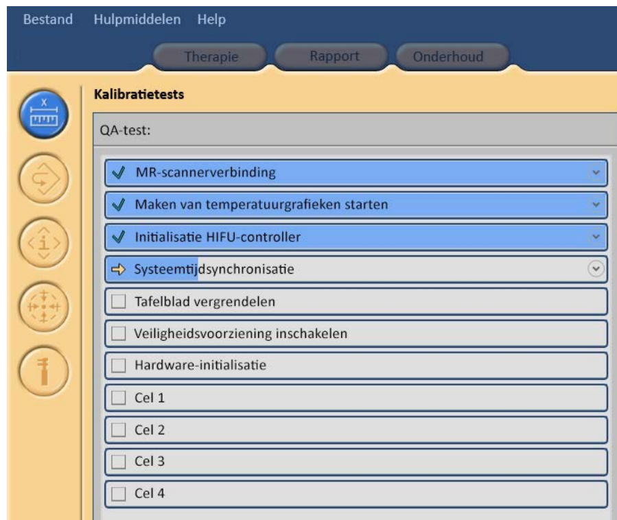
Afb. 116: De automatische QA-test heeft de eerste drie fasen met succes doorlopen en voert nu de Systeemtijdsynchronisatie uit.
