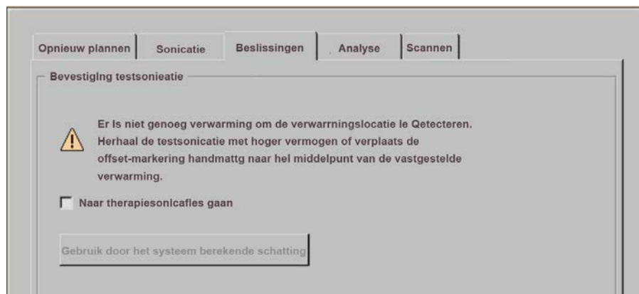
Afb. 93: Niet genoeg verwarming om de verwarmingslocatie te detecteren.
