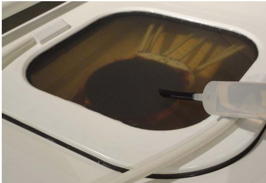
Afb. 104: De Sonalleve-patiënttafel met ontgast water voorbereiden op het fantoom.
