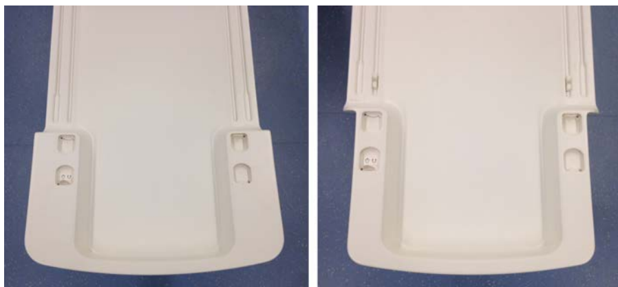
Abb. 53: Links: Dieser dünne Tischplattentyp von Ingenia muss entfernt werden, bevor die Sonalleve-Tischplatte in Position gebracht werden kann. Rechts: Das schmalere Ende dieses dünnen Tischplattentyps von Ingenia ermöglicht es, die Sonalleve-Tischplatte ohne Entfernen der dünnen Ingenia-Tischplatte in Position zu bringen.
