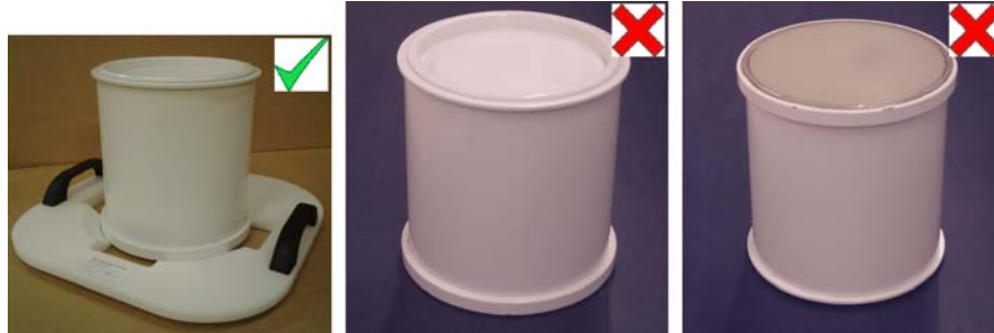
Abb. 115: Das QS-Phantom mit nach unten zeigender Membran auf der Platte für das QS-Phantom lagern.
