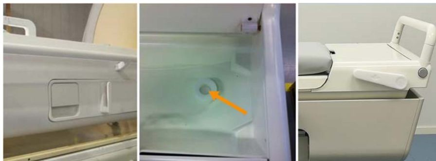
Abb. 9: Links: Griff zur Freigabe der Tischplatte. Mitte: Taste zur Notentriegelung der Tischplatte in der Zubehörbox. Rechts: Der Handgriff zur Notentriegelung der Tischplatte befindet sich an der Seite der Zubehörbox.
